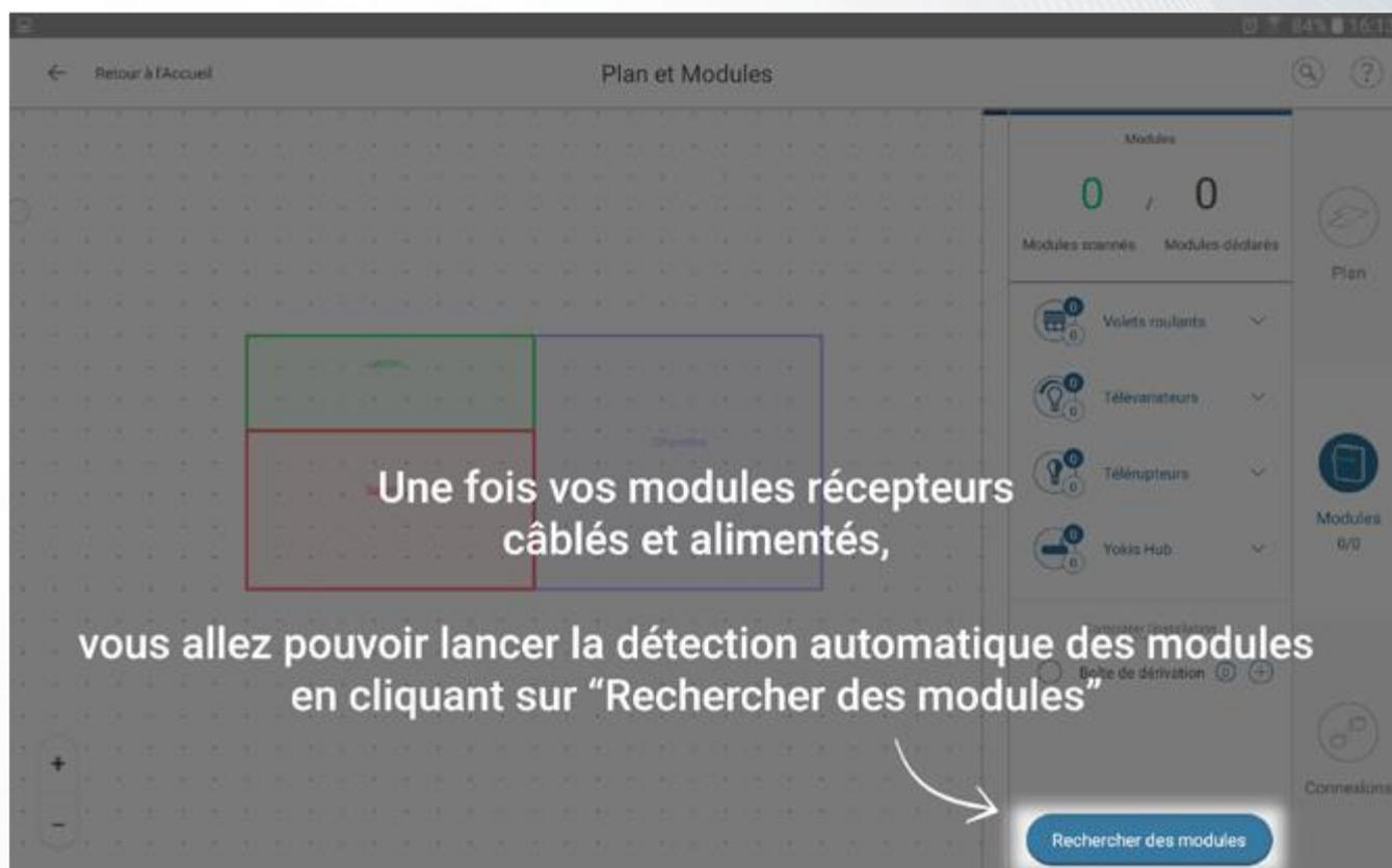
La recherche de module vous permet : de détecter automatiquement les modules V5 (boîtier vert) ou d'ajouter des produits antérieurs grâce au « scan manuel ».
