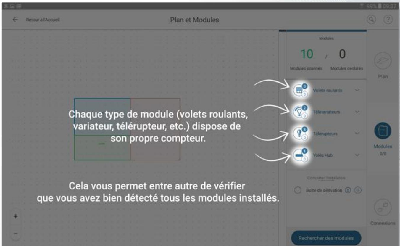
En cliquant sur un type de module, vous aurez accès à la liste des modules scannés et vous pourrez actionner chaque module (ex : faire flasher une lampe ou bouger un volet) afin d'identifier son positionnement sur le chantier.
