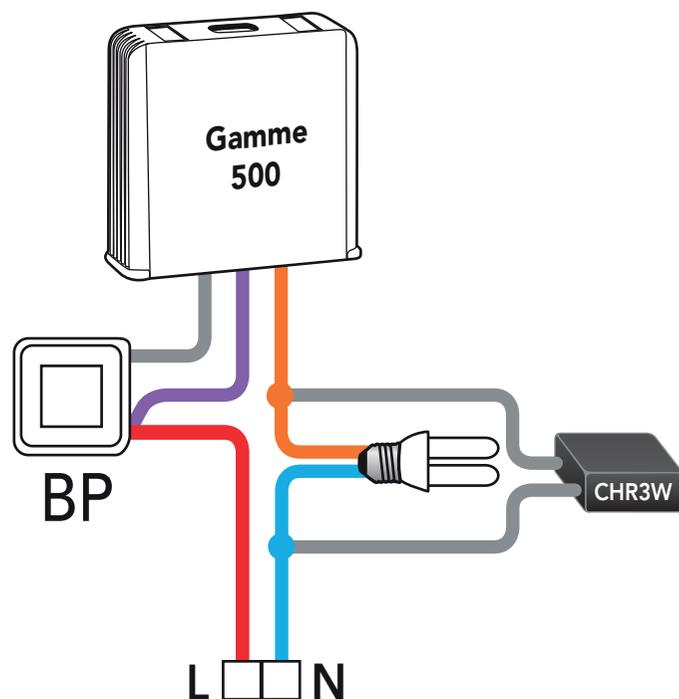
Lorsque la charge est constituée d'ampoules économiques standard ou LED il faut câbler en parallèle d'une des ampoules l'accessoire CHR3W.
